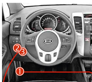
2 3 Салонный блок предохранителей
