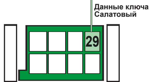
Левая зеленая часть 38-контактного разъема. Вид сзади.
