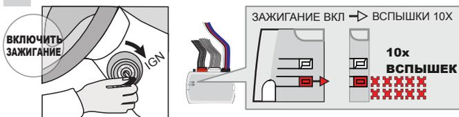
**Поверните** ключ в положение ON/RUN (включите зажигание).
