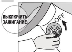
**Поверните** ключ в положение OFF (выключите зажигание).
