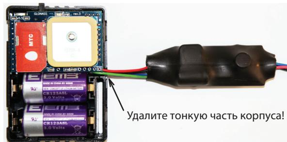
**Подключение 12В к 4-контактному разъему на верхней плате приведет к выходу устройства из строя. Поврежденное устройство гарантийному ремонту не подлежит.**
