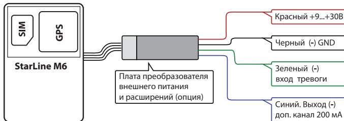
Для подключения платы преобразователя питания и расширений откройте крышку корпуса устройства и аккуратно снимите верхнюю плату. В белый 4-контактный разъем на обратной стороне снятой платы вставьте соответствующий разъем платы внешнего питания. Острым ножом удалите тонкую часть корпуса (см. фото на стр. 61), вставьте верхнюю плату на место, а провода выведите через образовавшееся отверстие в купусе.
