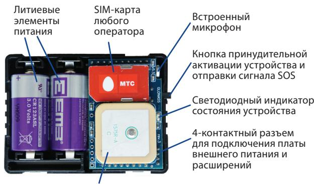
Антенна навигационного приемника (направлять в сторону неба!)
