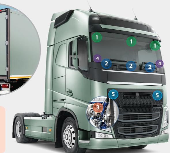
**3** Датчик температуры двигателя закрепите на патрубке системы охлаждения рядом с блоком двигателя.
