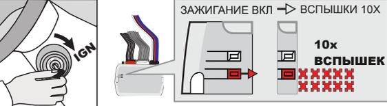
**Поверните** ключ в положение ON/RUN (включите зажигание).
