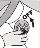
**Поверните** ключ в положение OFF (выключите зажигание).
