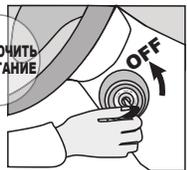
**Поверните** ключ в положение OFF (выключите зажигание).
