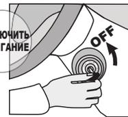
**Поверните** ключ в положение OFF (выключите зажигание).
