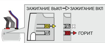
**Поверните** ключ в положение ON/RUN (включите зажигание).
