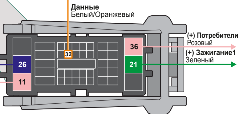
Черный 46-контактный разъем. Вид сзади.
