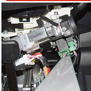
Разъем иммобилайзера на замке зажигания
