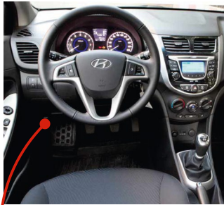
Салонный блок предохранителей
